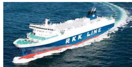
貨物を積んだトラックやトレーラーをそのまま載せて運ぶことができ、荷物を積み込む時間を大幅に短くできます。また、船のスピードも速く、生鮮食品などの輸送にも適しています。
